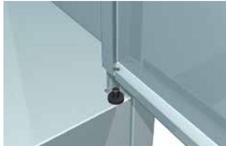
14. «Утопив» подпружиненный металлический наконечник верхней оси, завести дверь под верхнюю ось и совместить соответствующее отверстие в двери с осью до выщелкивания наконечника.
