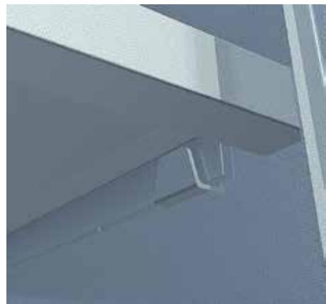
10. Установку перекладин необходимо начинать с самой правой секции ряда. Вставив заглушку в соответствующее отверстие правой боковины, поочередно установить перекладины, вставляя их в отверстия перегородок, по мере продвижения надевая на них крючки (по два в каждой секции) и фиксируя на перегородках двухсторонними заглушками. Затем установить заглушку на левую боковую стенку.
