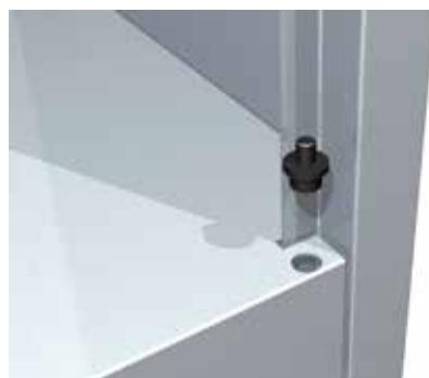
12. Вставить верхние оси в соответствующие отверстия крыши.
