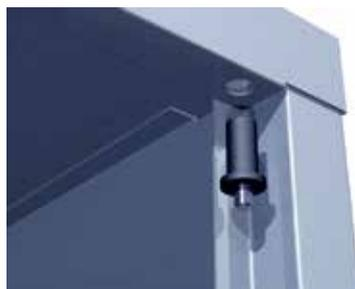
Надеть дверь соответствующим отверстием на ось с пластиковым наконечником. «Утопив» подпружиненный металлический наконечник верхней оси, завести дверь под верхнюю ось и совместить соответствующее отверстие в двери с осью до выщелкивания наконечника.
